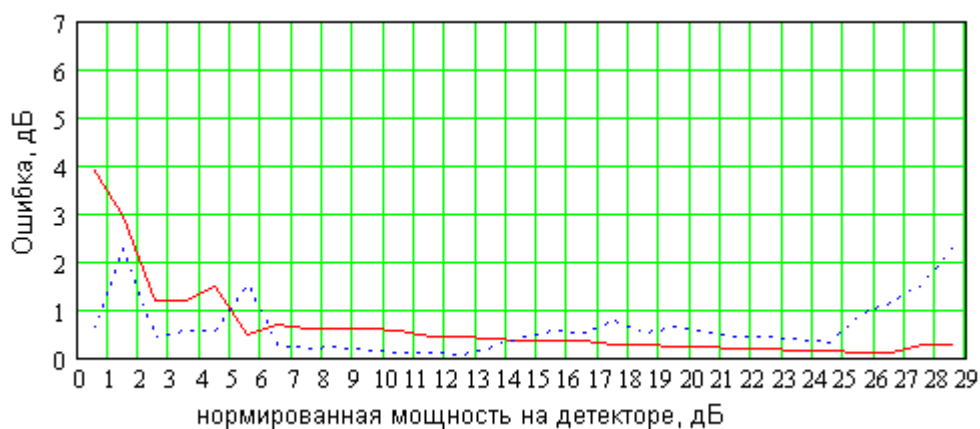
Рисунок 32 – Зависимость ошибки в дБ при изменении температуры для усилителя с арсенид - галлиевым диодом (синий график) и диодом Шотки (красный график).
