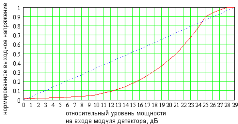
Рисунок 12 – Зависимость нормированного выходного напряжения модуля детектора от относительного уровня мощности входного сигнала (красная сплошная линия) и идеальная зависимость ( обозначена синими точками).
