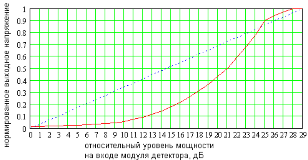
Рисунок 21 – Зависимость нормированного выходного напряжения модуля детектора от относительного уровня мощности входного сигнала (красная сплошная линия) и идеальная зависимость (обозначена синими точками).
