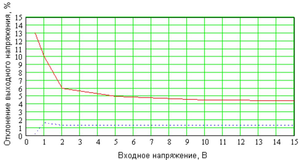
Рисунок 26 – График зависимости возможного отклонения выходного напряжения от входного напряжения при изменении температуры на 20 градусов.
