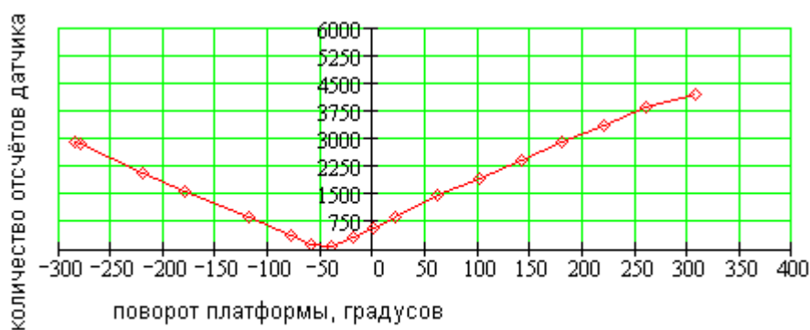
Рисунок 11 – Экспериментальная зависимость количества отсчетов датчика от угла поворота платформы .
