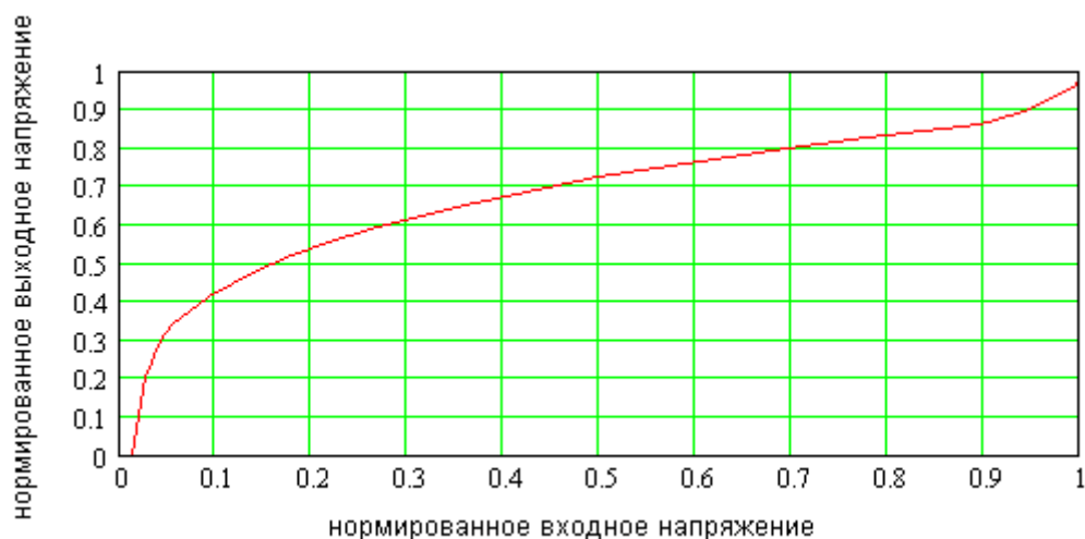
Рисунок 13 – зависимость требуемого нормированного выходного напряжения корректирующего усилителя от нормированного входного напряжения.
