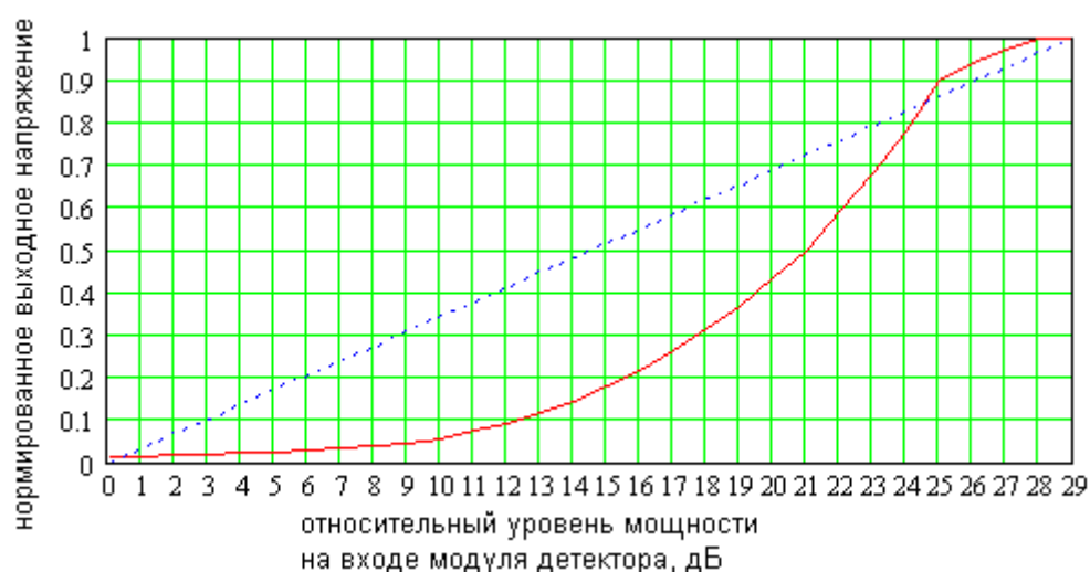
Рисунок 3.10 – Зависимость нормированного выходного напряжения модуля детектора от относительного уровня мощности входного сигнала (красная сплошная линия) и идеальная зависимость (обозначена синими точками).
