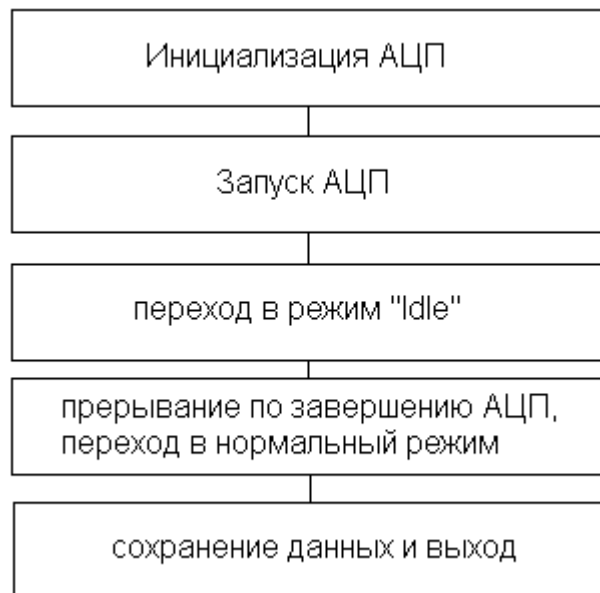
Рисунок 2.12 - блок – схема алгоритма функции АЦП.
