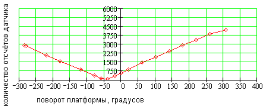
Рисунок 2.5 – Экспериментальная зависимость количества отсчётов датчика от угла поворота платформы .
