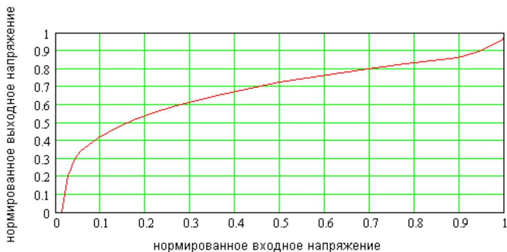
Рисунок 3.11 – Зависимость требуемого нормированного выходного напряжения корректирующего усилителя от нормированного входного напряжения.
